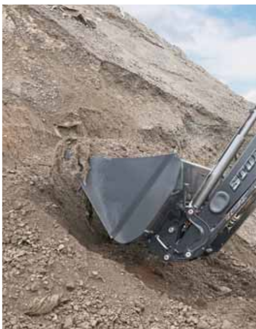
Благодаря функции дозачерпывания утраты груза из-за рассыпания сводятся практически к нулю.
