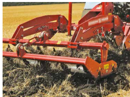
Балансирная установка шпорового катков
