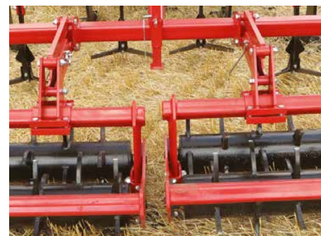
Преимущества шпорового самоочищающегося катка
