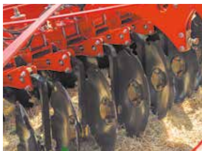
Стойки из высокопрочной стали
