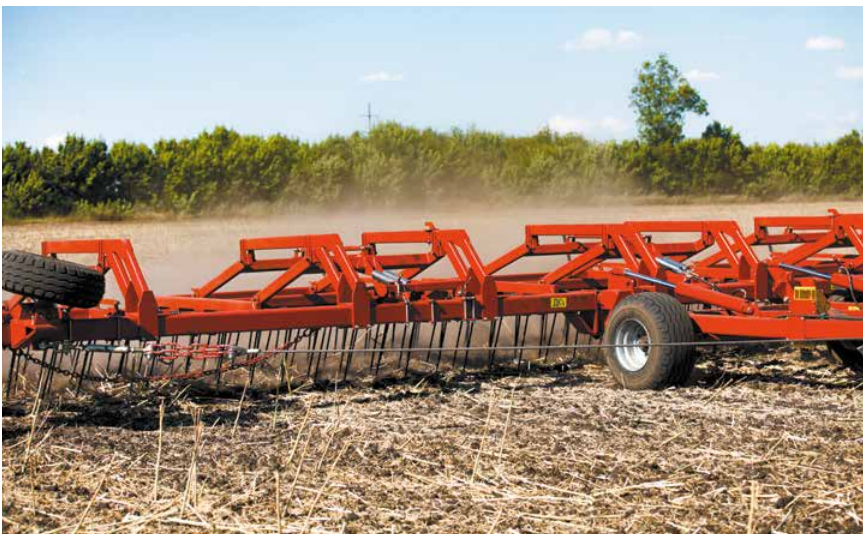
Тросовое натягивания секций
